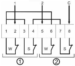
S: contact de sécurité W: contact de travail 1 : sens de rotation 1 2: sens de rotation 2
